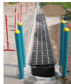
Canaux venturi et débitmètres à l'exutoire des parcelles expérimentales (à gauche) et du bassin versant de Rouffach (à droite)
