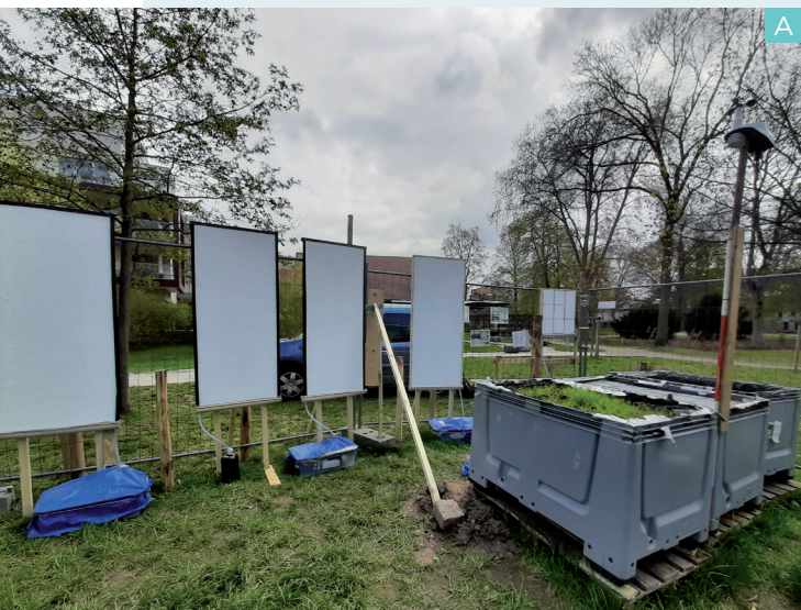
Modèles réduits de façades et de colonnes de sol avec plusieurs types de couverts urbains (graviers, pavés, enherbés)
