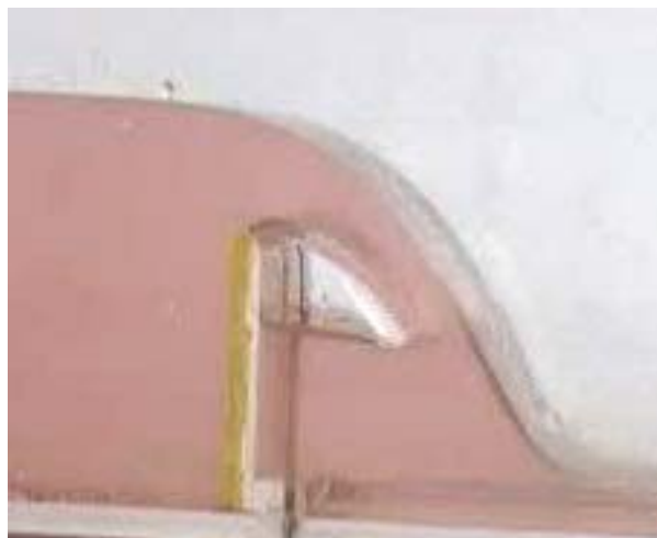
seuil avec nappe aérée
